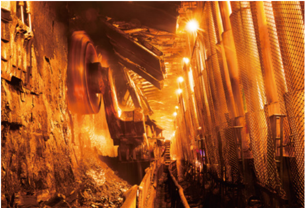
上湾煤矿建成国内首个 8.8 米大采高智能综采工作面，单产达 146 万吨 / 月，单井单面产量最高、效率最优、效益最好
